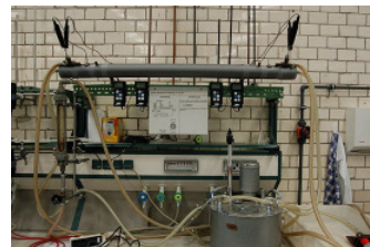
Versuch Wärmeaustausch im Rohr
